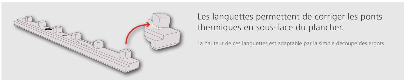
Les languettes permettent de corriger les ponts thermiques en sous-face du plancher.
