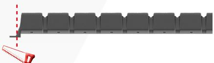
En cas de pose contre un mur existant (en rénovation), découper d'abord le rebord de l'obturateur.
